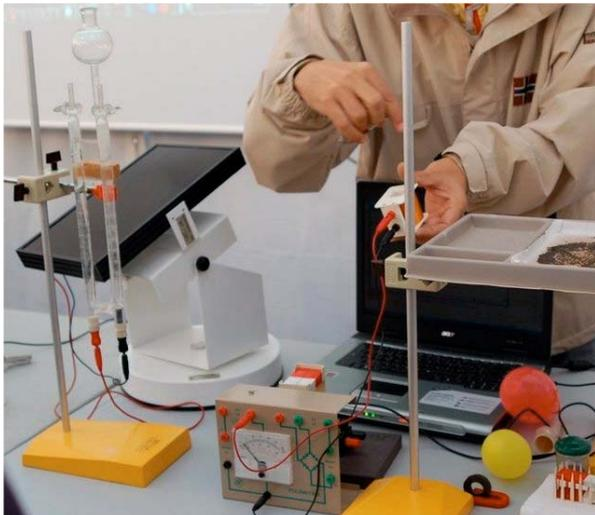
5. Aproximamos un imán, bajo la bandeja, a limaduras de hierro distribuidas homogéneamente. Observamos cómo las limaduras se “orientan” y adoptan diferentes formas según el tipo de imán
